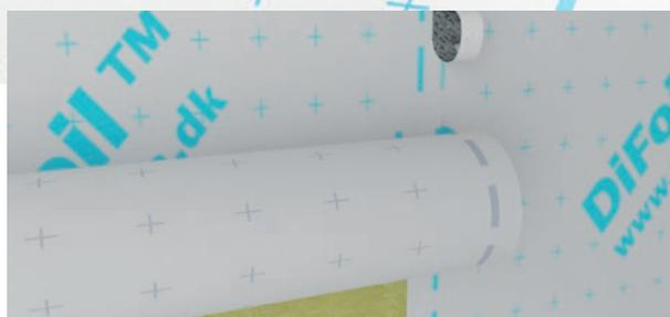
DAFA DiFoil består af Polyethylen (PE) banevare belagt med fugtabsorberende Polypropylen (PP) fliesdug. Materialet tåler direkte sollys i maks 3 mdr. og må ikke udsættes for direkte kontakt med træimprægning tilsat opløsningsmidler.
