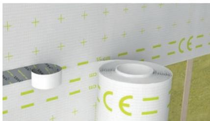
DAFA ExFoil består af Polyethylen (PE) banevare, armeringsnet i midten og er belagt med fugtabsorberende Polypropylen (PP) vliesdug. Materialet tåler direkte sollys i max. 3 mdr. og må ikke udsættes for direkte kontakt med træimpregnering tilsat opløsningsmidler.
