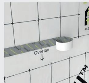
DAFA Hi-tack® tape er ekstremt stærk. Det betyder tætte samlinger og dermed holdbare, fugtadaptive dampspærreløsninger.
