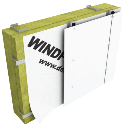
DAFA WindFoil 95 som vindsperre i ventilert ytterveggskledning
