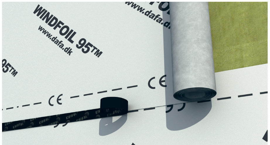
DAFA WindFoil 95 som vindspærre monteres med 150 mm overlæg, og frie samlinger tapes med DAFA UV tape.
