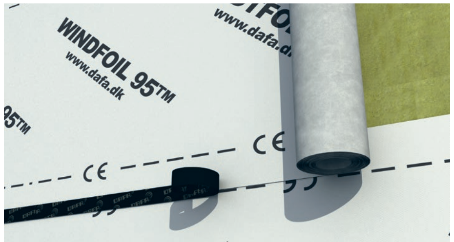
DAFA WindFoil 95 som vindspärr monteras med 150 mm överlappning och skarvar tejpas med DAFA UV-tejp.
